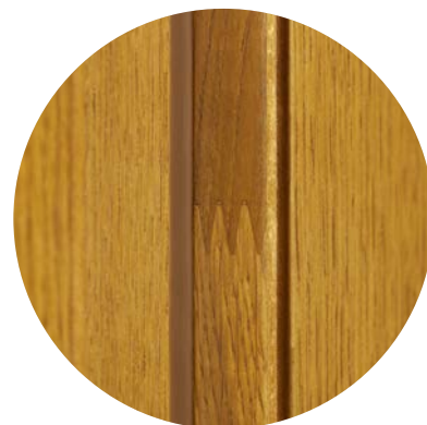
Różnice kolorystyczne łączeń**
